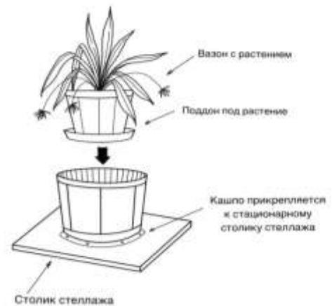
Рисунок 2. Устойчивое крепление (прикручивание) кашпо к столику стеллажа и/или стойки и установка вазона с растением и с поддоном в кашпо
